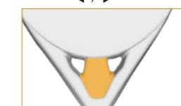
Molde diseñado con una inserción de fibra en el corazón de la pala.
